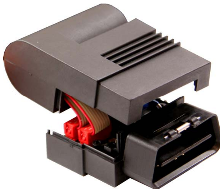
Рис. 21 Модуль OBD с разъединенными частями корпуса
