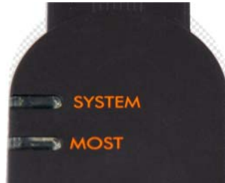
Рис. 12 Светодиоды на корпусе ICOM B
