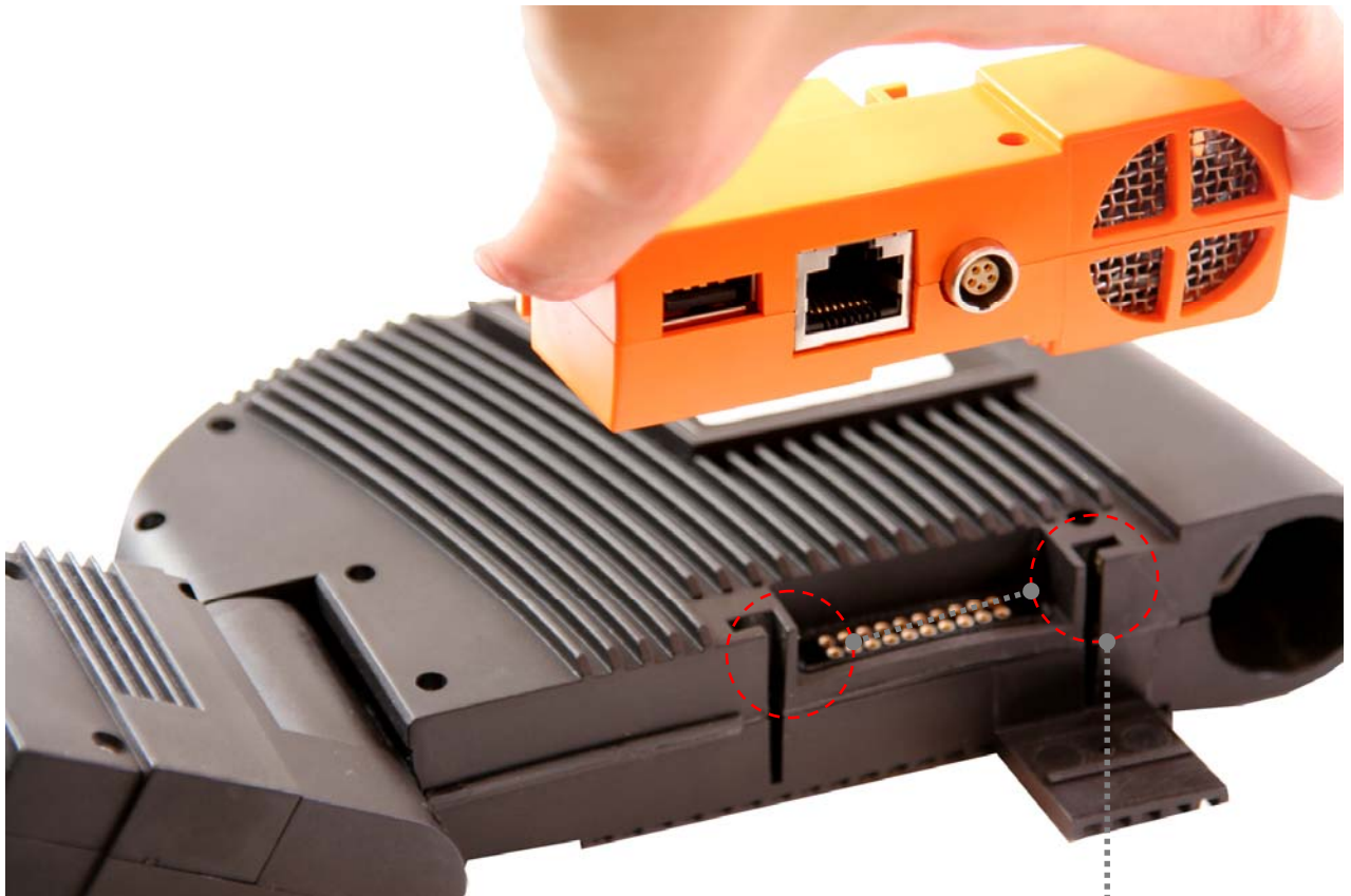
Рис. 17 Снятие/установка блока разъемов
